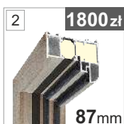
Ościeżnica aluminiowa ALU/90 trzykomorowa z podwójnym uszczelnieniem z przegradą PCW wypełnioną pianą
